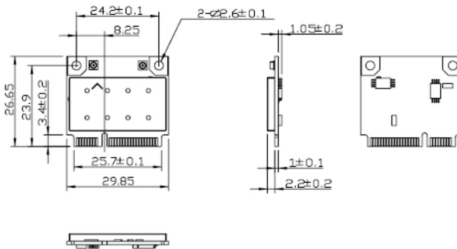
Tolerances unless otherwise specified :  $\pm 0.15\text{mm}$
