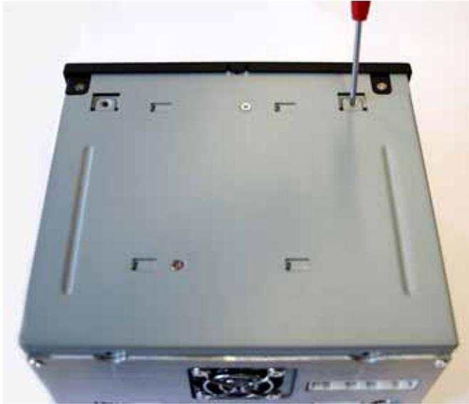
Ziehen Sie den Gehäusedeckel leicht nach hinten und nehmen Sie diesen ab.
