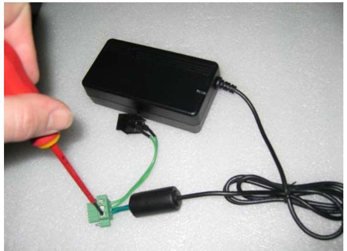
Nun muss +12 V und GND (Masse) etwas auseinander gezogen werden, da beim FleetPC-6 +12V und Masse links und rechts am Stecker liegen. (Achtung: eventuell muss die grüne Isolierung etwas weiter entfernt werden.)
